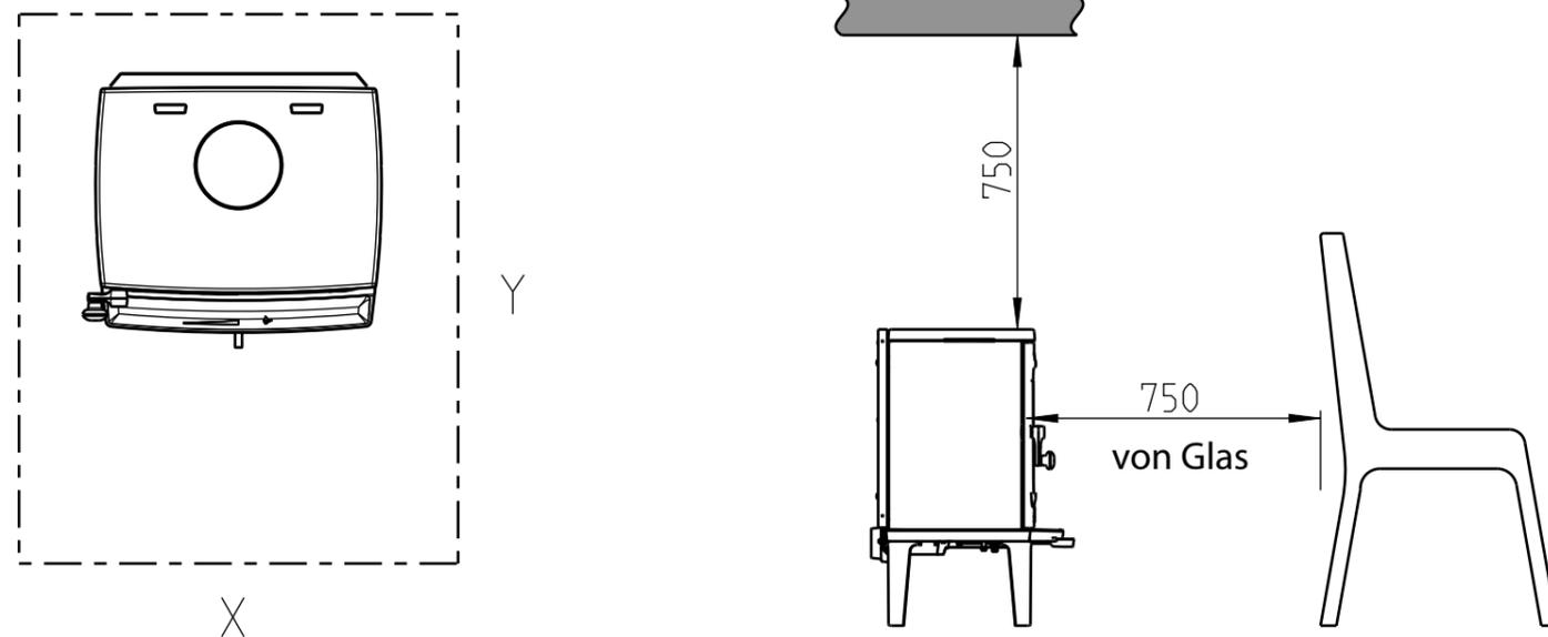
Min. Abmessungen der Fußbodenplatte
