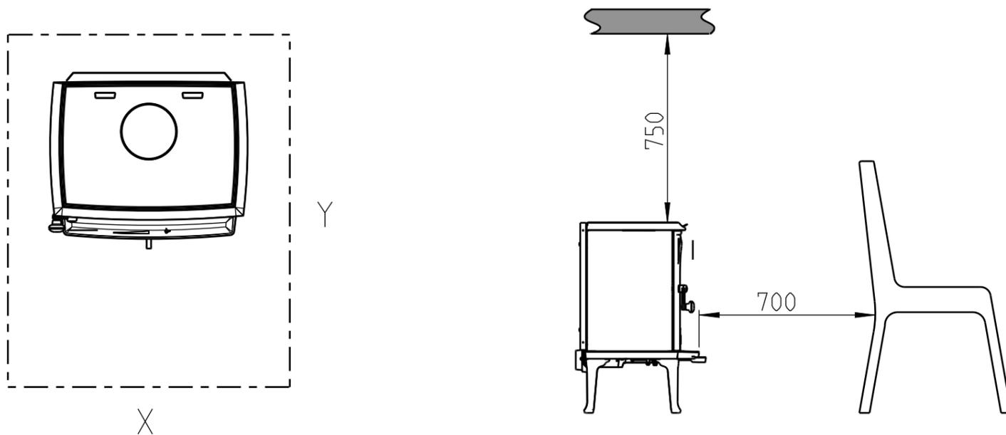
Min. Abmessungen der Fußbodenplatte
