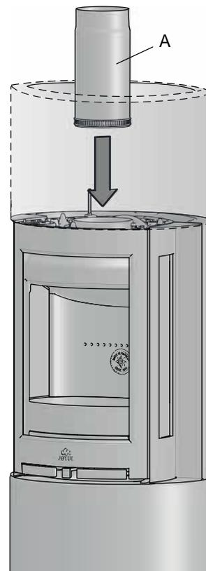
13. Führen Sie das Rauchgasrohr (**A**) in den Abzug an der Oberseite.
