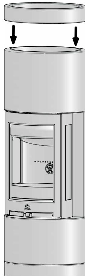
19. Setzen Sie den oberen Abschlussring (Abb. 1 - Komponent 14) auf.
