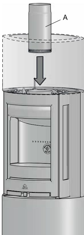
21. Führen Sie das Rauchgasrohr (A) in den Abzug an der Oberseite.
