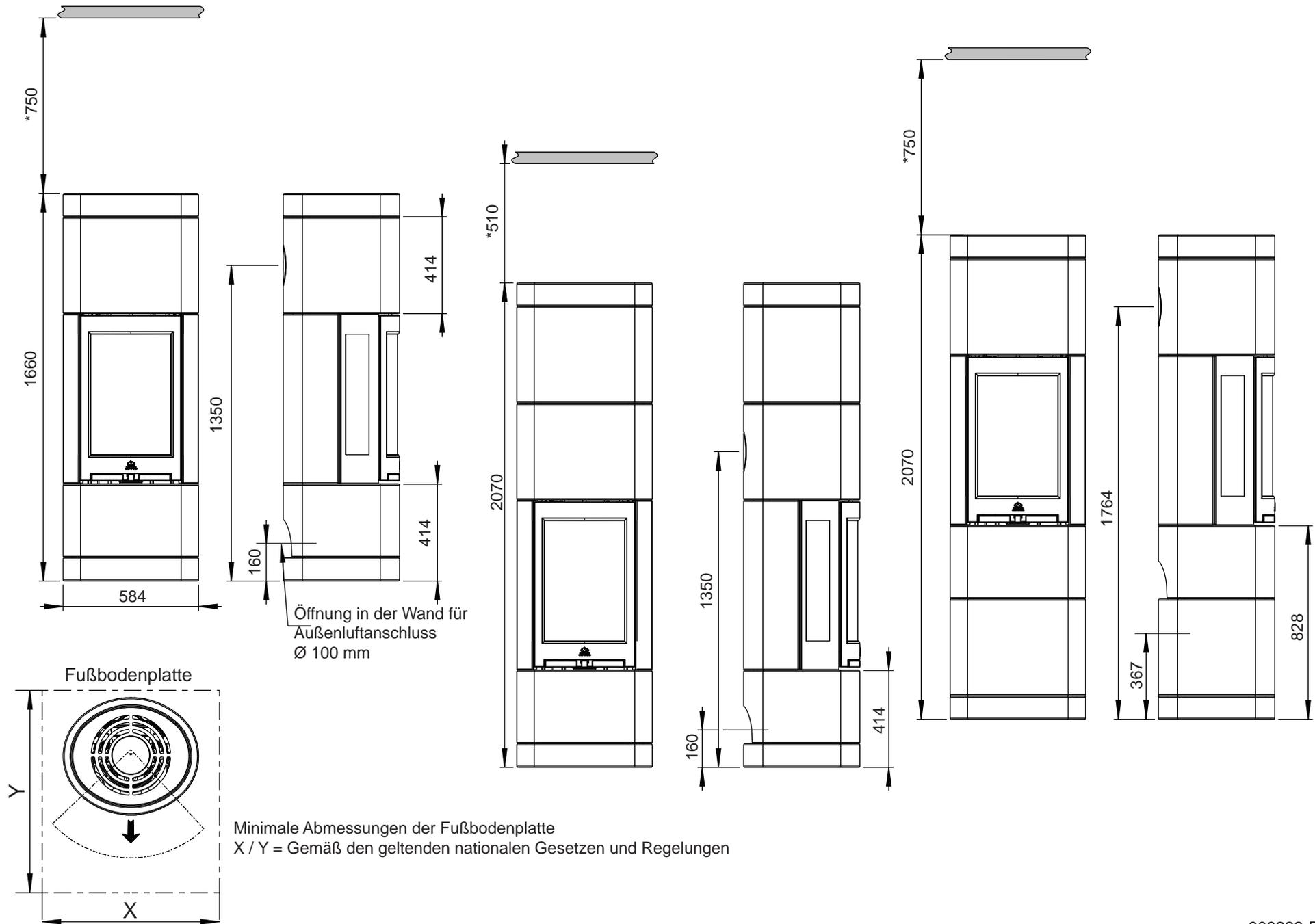
Öffnung in der Wand für Außenluftanschluss Ø 100 mm
